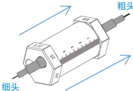
(4) 将你要用的那个刻度朝上，所示数字即代表此时孔位轴心（笔芯）的垂直高度，翻滚划线器即可切换划线高度。（如需使用 17.5，注意将划线笔插到副孔）
