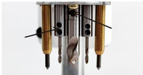
②拧掉螺丝后，卸下旧钻头，更换备用钻头时，需将其向上顶到位，且要确保两个小钻头高度统一，然后拧回螺丝即可。
