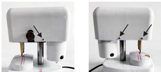
②打开后可看到两根皮带（如图），更换对应尺寸的备用皮带即可。
